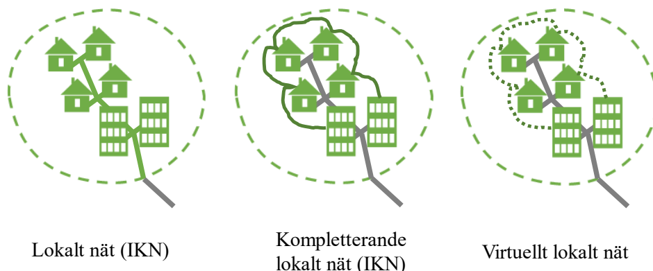
Figur 2: Stilistisk bild över de olika möjliga nätstrukturena för delning av el, där lokalt nät innebär att en privat aktör helt tar över elnätet för distribution mellan användarna (IKN) och kompletterande lokalt nät (också ett IKN-nät) är en kompletterande ledning mellan huskroppar. Båda dessa utgör en fysisk infrastruktur. Det virtuella nätet efterliknar ett fysiskt nät i avseende flera funktioner, nyttjar istället en digital avräkning.
